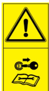
**ВНИМАНИЕ!** Перед началом технического обслуживания и проведения ремонтных работ заглушите двигатель и выньте ключ из замка зажигания.
