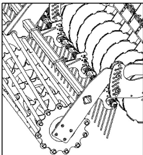
Регулировка установки задних боронок по высоте (рис. 14) путем их перестановки в кронштейнах крепления. При правильной установке задние бороночки не должны допускать выброса земли на задние катки и касаться поверхности земли.
