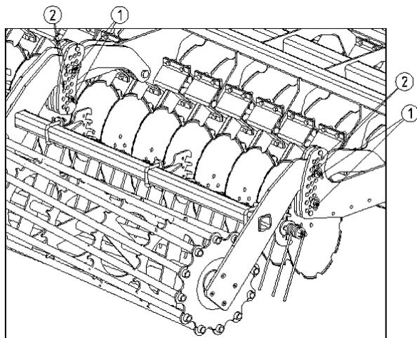
Регулировка установки задних катков (рис. 13) осуществляется путем перестановки штырей (1) в различные отверстия (2) рамы агрегата.
