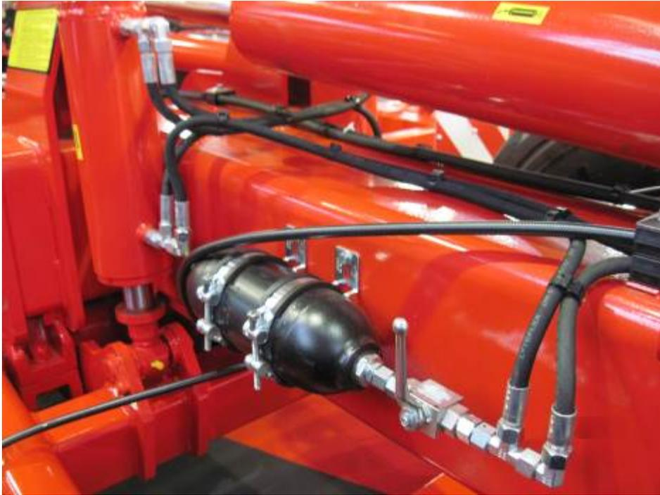
Рисунок 6. Азотный гидроаккумулятор опорных колес в рабочем положении
