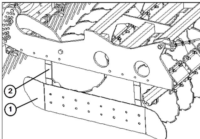
Регулировка дефлекторов (рис. 15) осуществляется путем перестановки дефлектора (1) в различные отверстия пластины крепления (2).
