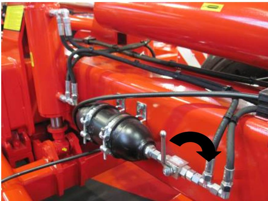
Рисунок 10. Азотный гидроаккумулятор опорных колес в транспортном положении
