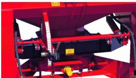
Гидравлическое, дистанционное управление подачей минеральных удобрений
